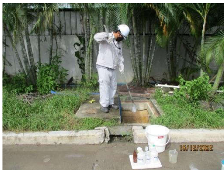
ภาพที่ 3.2.4-1 การเก็บตัวอย่างน้ำทิ้ง
